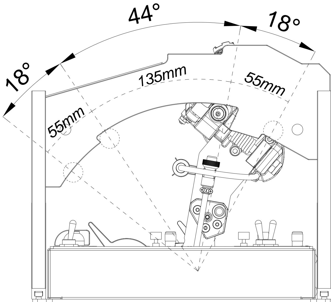
运动总行程为  $80^\circ$  (停车档行程  $18^\circ$ 、工作档行程  $44^\circ$ 、加力档行程  $18^\circ$ )；
