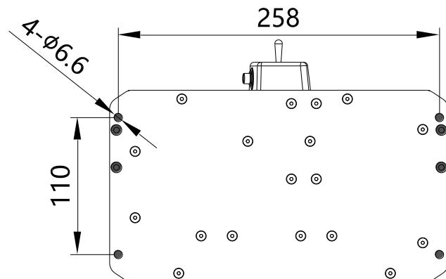
底部外接孔如图按需连接支架或底板
