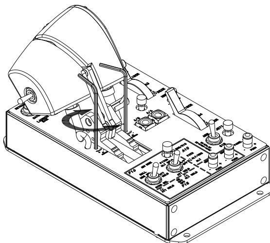
内六角扳手通过标识孔洞后对准螺钉头扭动即可调整对应把手的阻力（顺时针转动为加大，逆时针转动为减小。）
