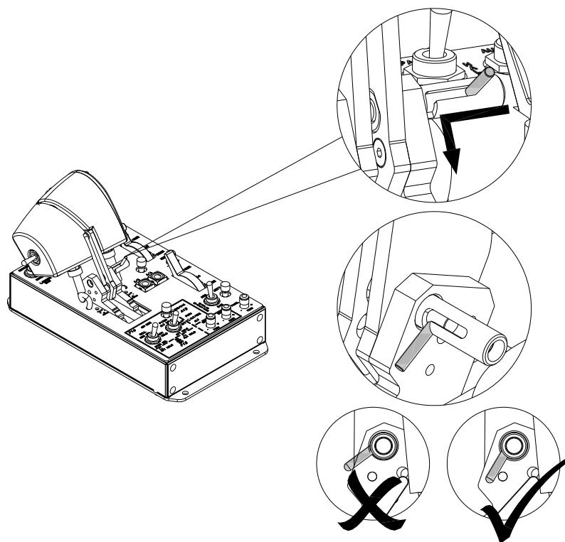
两把手对齐后拨动图示同步手柄并锁止，使销子插入孔洞内即可实现左右把手同步运行（同步手柄需完全锁止，否则易触发开关）。
