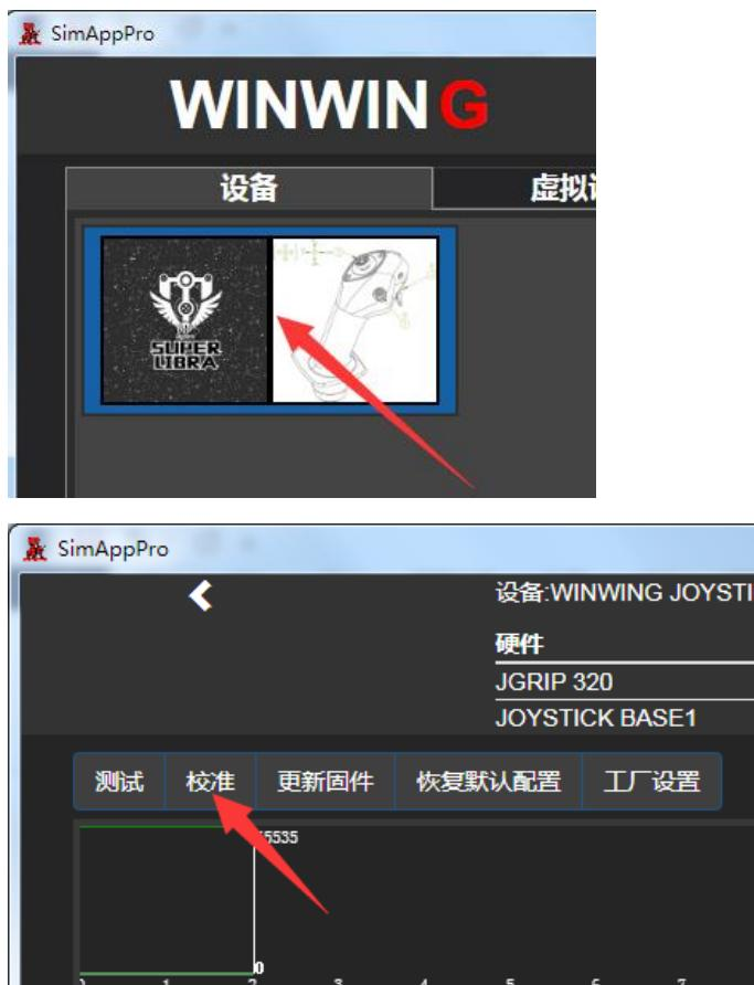
② 在校准页面，点击下图两按钮开始校准，然后全行程移动迷你摇杆；
